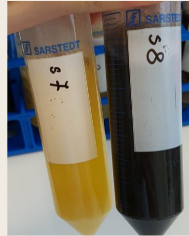
Bilde nr. 1 Den primære oppformeringskulturen i Half Fraser. s7 viser negativ reaksjon. s8 viser positiv reaksjon.
