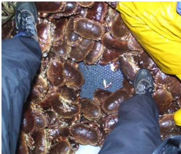
c) Bunnen av lasterommet med den falske perforerte bunnen
