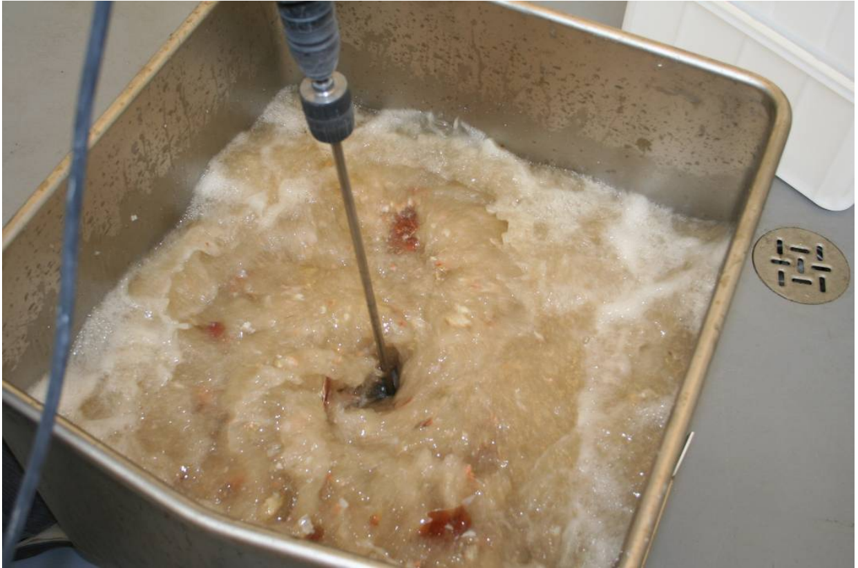
Figur 3. Vasking av krabbeskall med kraftig omrøring.
