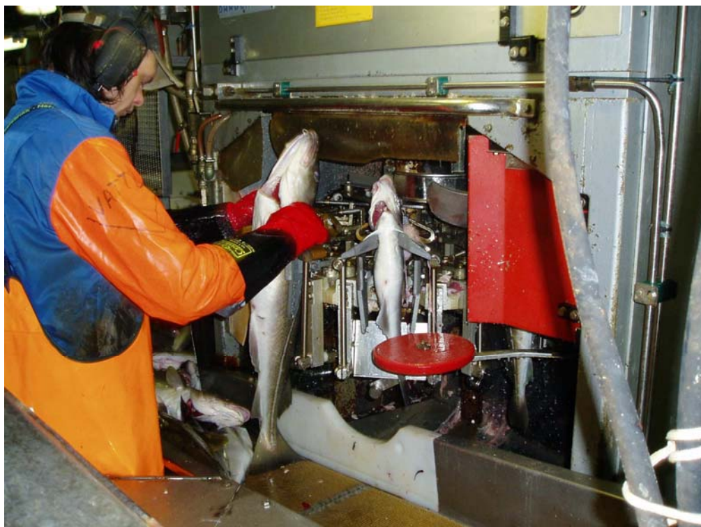
Bilde 15: Manuell mating av hodekapper, med nødstop
