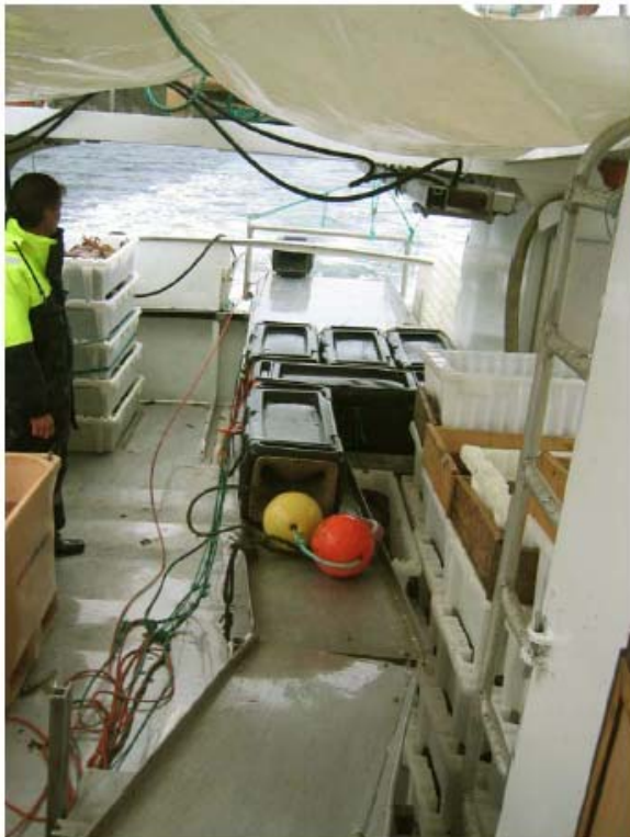
Bilde 7: Setting av krabbeteiner med ilettau og lenketau liggende på dekk
