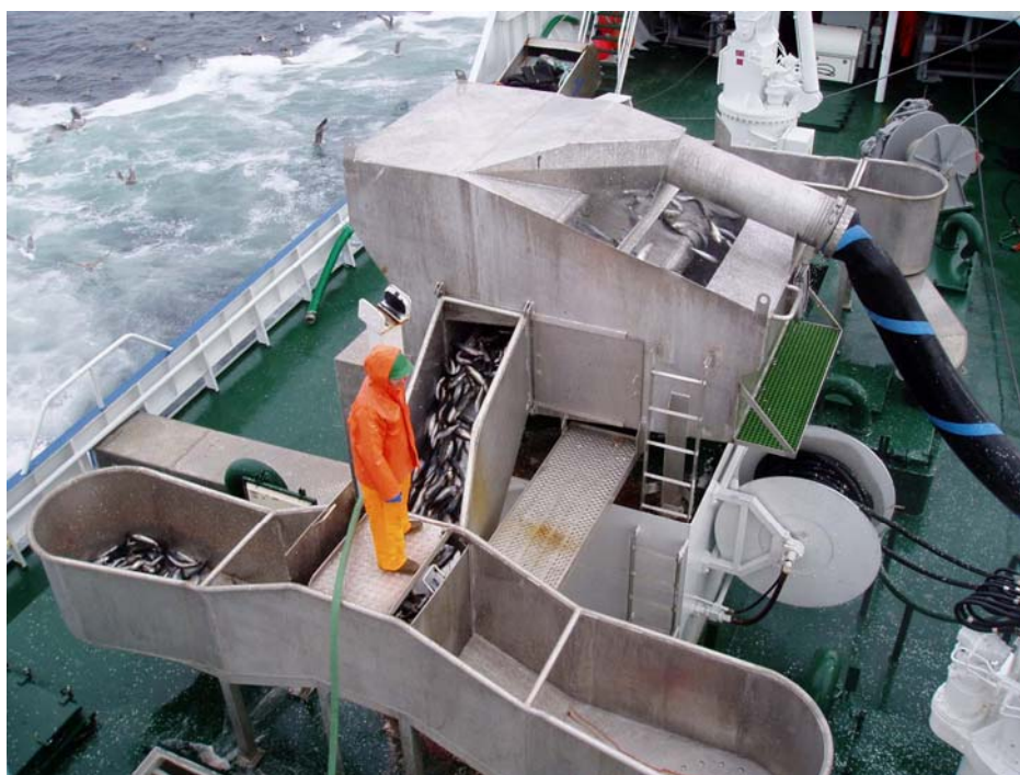
Bilde 12: Innpumping av sild og fordeling til ulike lastetanker
