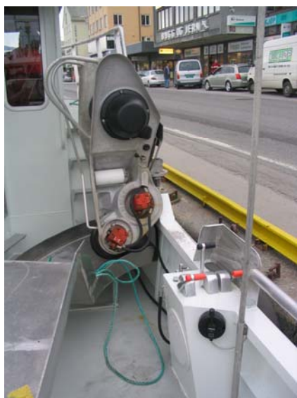
Bilde 21 Styrbord side på "Charlie". Garnhaler er vippet opp. Mye av fiskerens arbeidsdag foregår ved manøverstasjonen bak garnhaleren.
