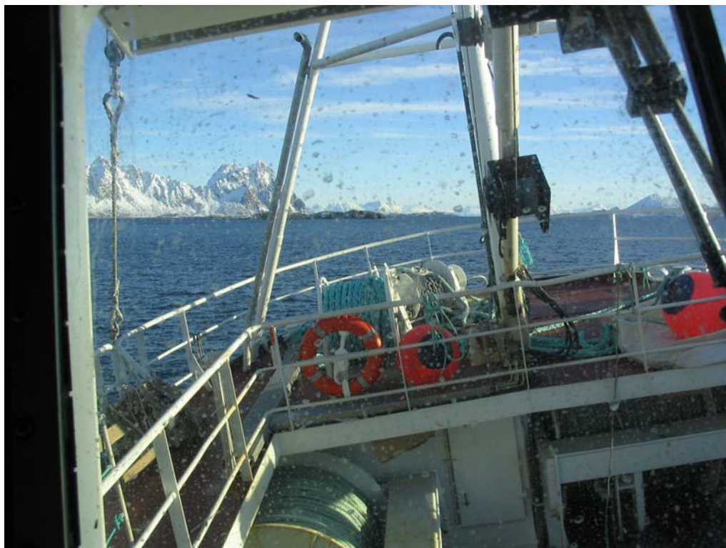
Bilde 7 Feltprøve med en 80 fots kystfiskebåt som er rigget for not og snurrevad. Båten rullet mye selv i helt rolig sjø ved tomme lastetanker.
