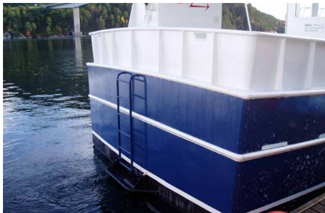
Bilde 20 Fast montert redningsleider på hekken til MS "Charlie"
