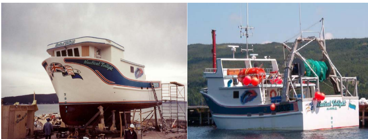
Bilde 5 Fiskebåt bygget i Canada, lengde 47 fot, bredde 7 meter. Foto Lofoten Shipbrokers.
