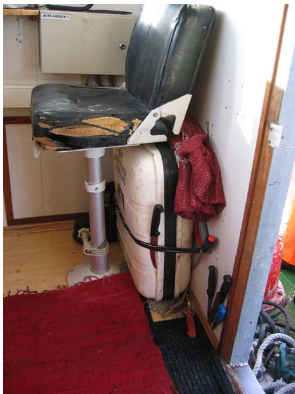
Bilde 22 Oppbevaring av redningsflåte i styrehuset. Tid er en viktig faktor ved forlis og fisker må ha muligheten til hurtig å sette redningsflåten på sjøen. Å oppbevare flåten i styrehuset kan bli for tidkrevende.
