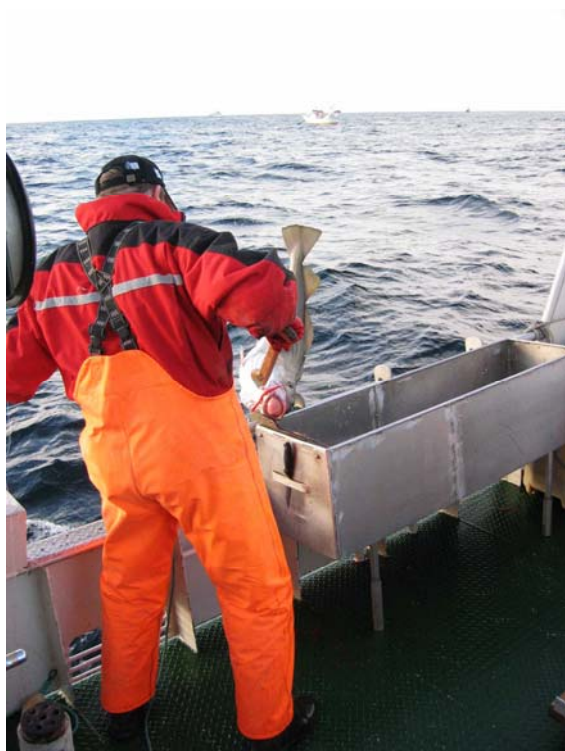
Bilde 8 Lav rekkehøyde øker faren for fall over bord. En rekke fartøy er bygget med rekker som ikke tilfredsstillt regelkrav.
