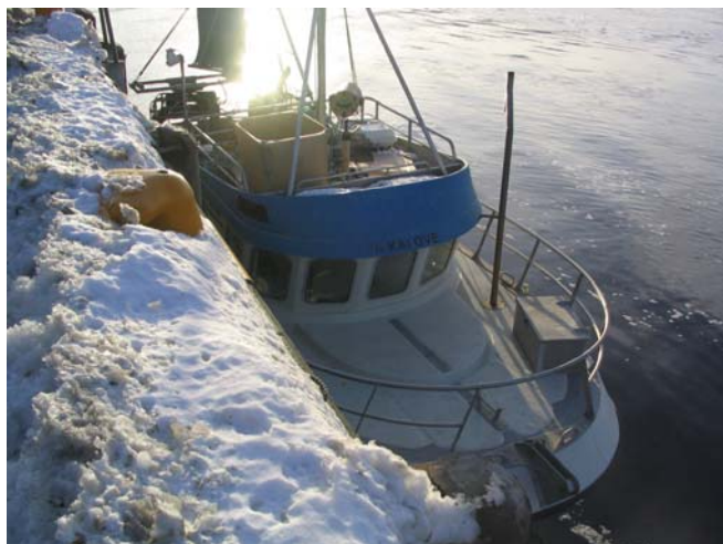
Bilde 16 Felttur med MS "Kai Ove". Snøskavl på kaikanten ved kai i Trondheim vanskeligjør kranoperasjon og atkomst.
