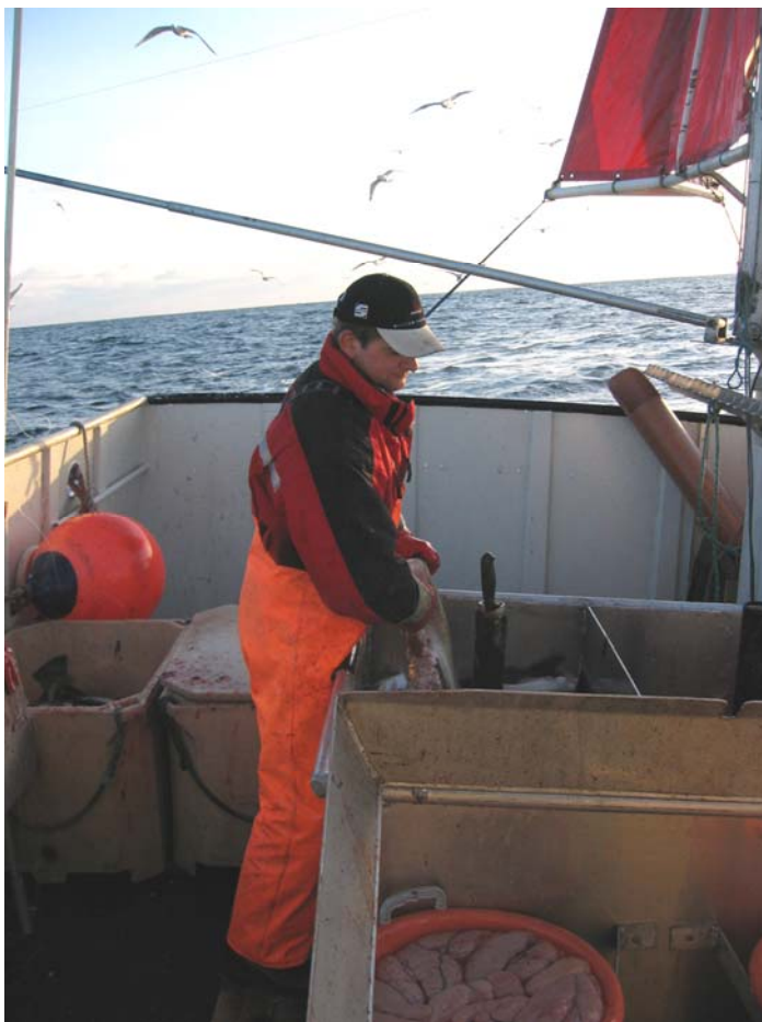
Bilde 21 Arbeid ved sløyebinge på MS "Argus". Her har fisker få støttemuligheter. Juksabåter har generelt mindre dekkstrustning enn garnbåter, noe som gir færre muligheter for støtte under arbeidet.
