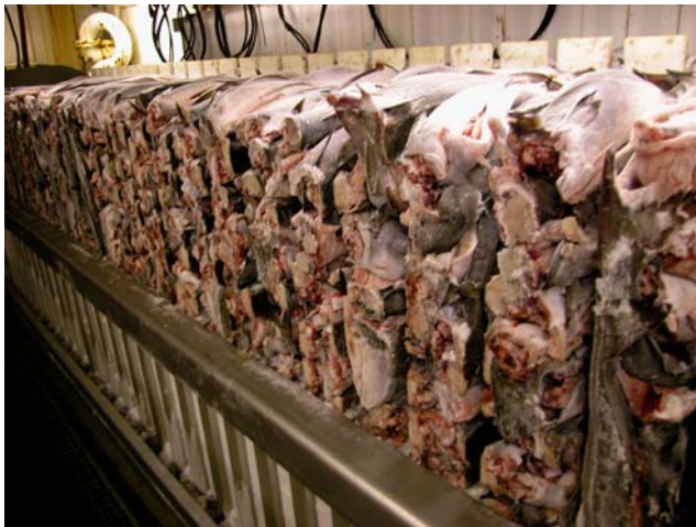
Bilde 12. Fiskeblokker som er ferdig fryst og klar for pakking. Bildet til høyre viser pakking av fryste blokker
