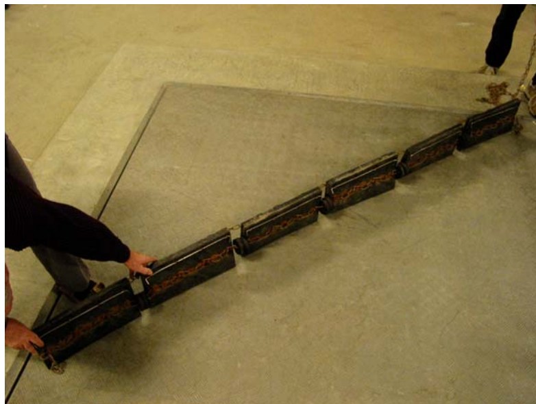
Figur 2. Prototype av sidegear laget av gummiplater
