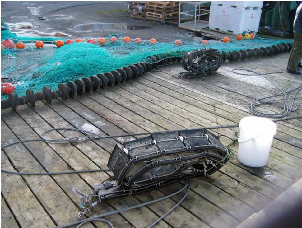
Figur 7. 1:2 skala modell av torsketrål med 10" rockhopper gear (sammenrullede plater utgjør et sidegear)
