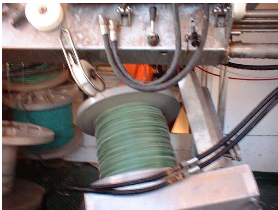
Bilde 6: Lineryggen og begge ilene kveiles på og av samme trommel
