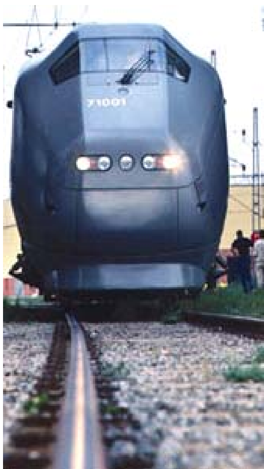
Figur 3.18: Front og plog på Flytoget er laget i sandwich med glassfiberarmert fenol i huden og et brannresistent skum i kjernen. Både front og plog fremstilles ved injisering.
