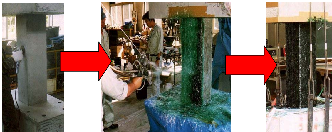
Figur 26: Spray-up: Blandingen av korte fiber og resin sprayeres på produktet
