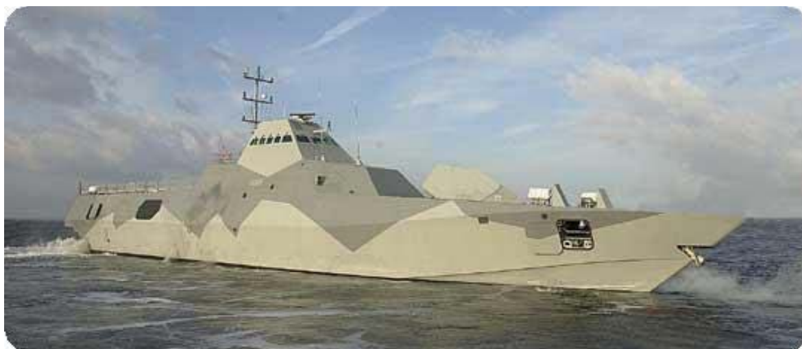
Figur 3.4: Korvett i Visby klassen bygd i sandwich med karbonfiber i hudlaminatene. Fartøyet er bygd ved Karlskronavarvet i Sverige.
