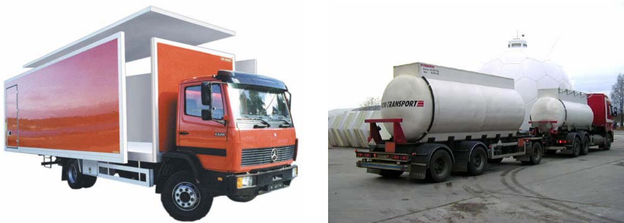
Figur 3.22: Eksempler på bruk av kompositt-/sandwich materialer i lastebilskap og i transporttanker for spesialvæsker. Sandwichpanelene og transporttankene på figuren er produsert av SelcoTek AS i Drammen
