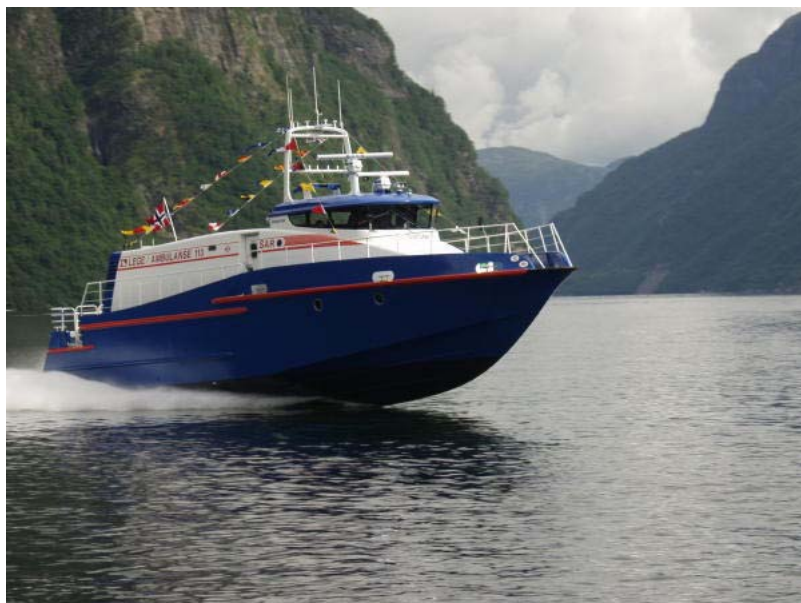
Figur 3.8: Rygerdoktoren. Ambulansefartøy i karbonfiber-sandwich produsert ved vakuuminjisering.
