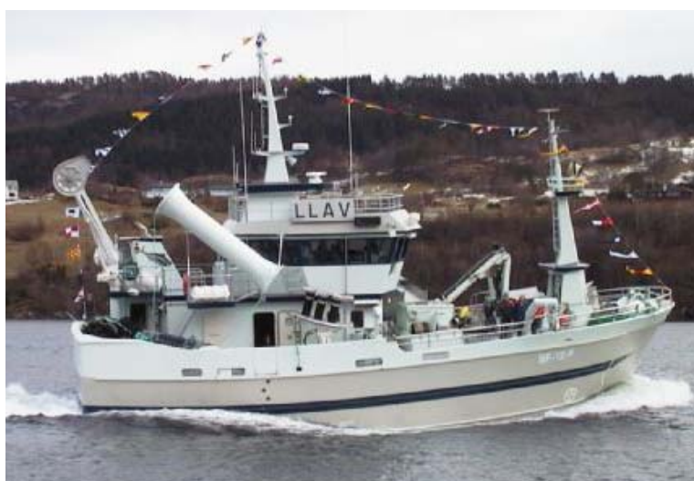
Figur 3: "Bluefin", et 70 fots fiskefartøy i sandwich produsert av Mundal Båt AS..
