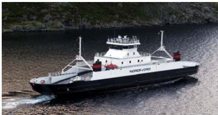
Figur 2: Sandwichoverbygg til kystfergen MS Nordfjord
