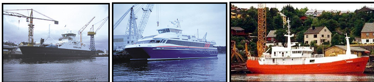
Figur 2: Eksempler på større fartøyer med overbygg i sandwich. Fra venstre: M/S Nordfjord (ferge, 72 m), M/S Fjordtroll (passasjerbåt) og M/S Solgunn (fiskefartøy, 60 m).
