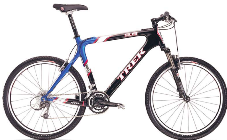
Figur 3.21: Eksempel på terrengsykkel med ramme i karbonfiberarmert epoksy.
