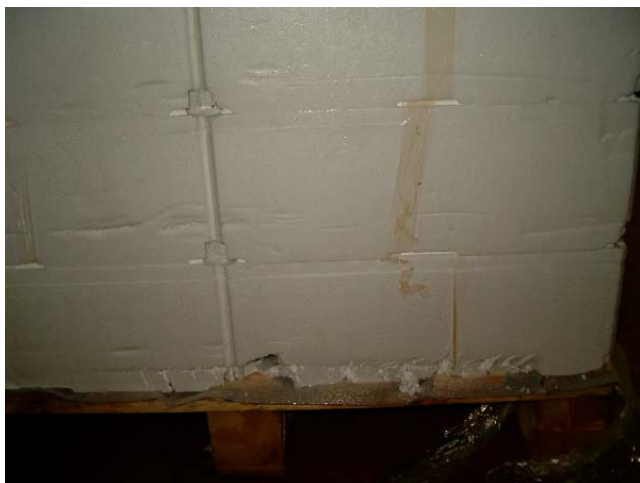
Figur 5. Liten transportskade på nederste lag av EPS-kasser
