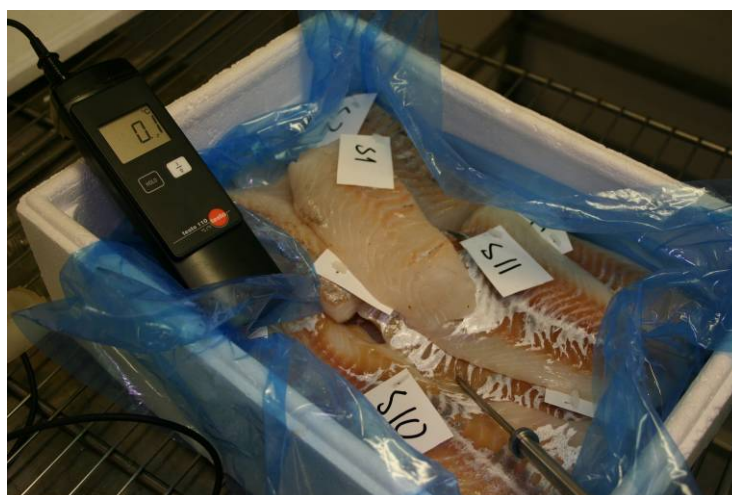
Bilde 4 Temperaturen i superkjølte filetstykker 4 dager etter pakking var +0,1 °C.
