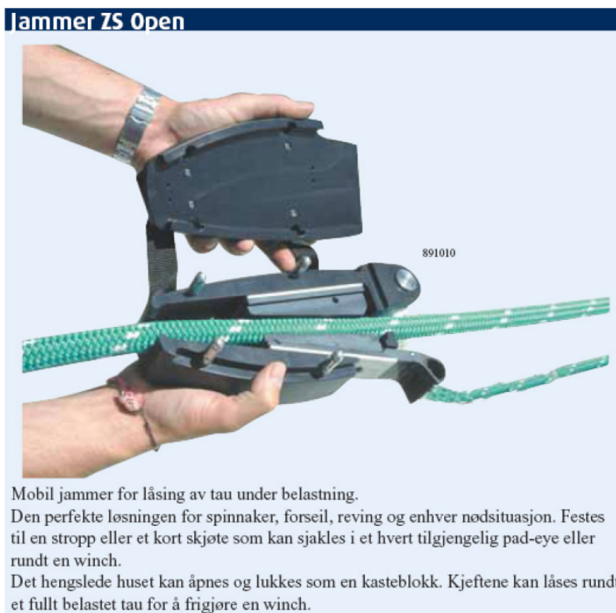
Figur 14. ZS Jammer, en eksisterende taulås for bruk på seilbåter. Utforming og funksjon falt i smak hos arbeidsgruppen. (Kilde: Spinlock, www.spinlock.co.uk )
