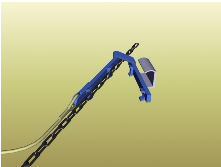
Figur 19. Forslag til kjettinglås i håndholdt utgave. Låsen klipses fast over kjettingen.
