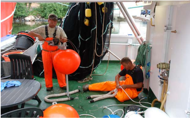
Figur 5. Rigging av opphalingsvinsjer for flatbunn i merden.
