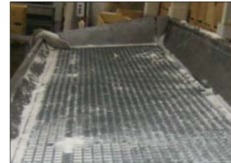
Figur 4: Viser rist hvor kar med fisk og salt blir tippet over på og hvor fisk og salt blir sortert.
