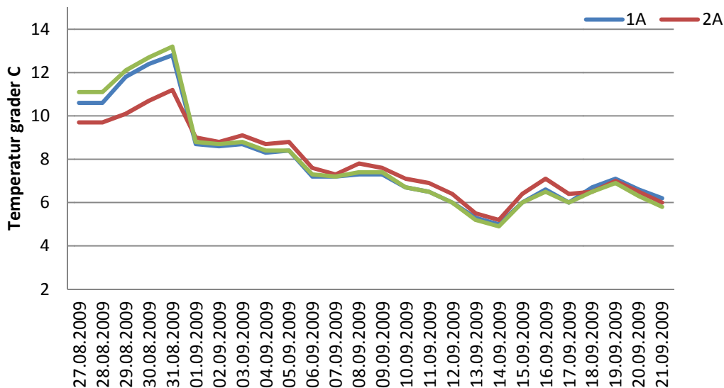
Figur 2.5. Temperatur loggerer under salting i kar (27.08 -31.08 ) og modning (31.08-21.09).
