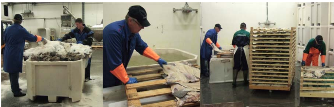
Figur 2.6. Behandling av saltfisk før tørking: fisk blir "banket" fri for salt, skylt og lagt på tørkevogner
