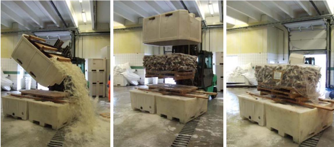
Figur 2.4. Kar blir snudd, merket og tildekt med plast.
