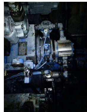
Bilde 4: hydraulikkanlegg påmontert gir hos deltaker
