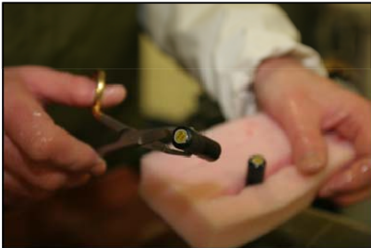
Figur 15 SmartTag-digital (STd) merket er 39 x 13 mm, veier ca 7 gram i vann og har en estimert batterilevetid på 7 - 12 måneder. Foto: Frank Gregersen / NOFIMA og Thelma Biotel AS.
