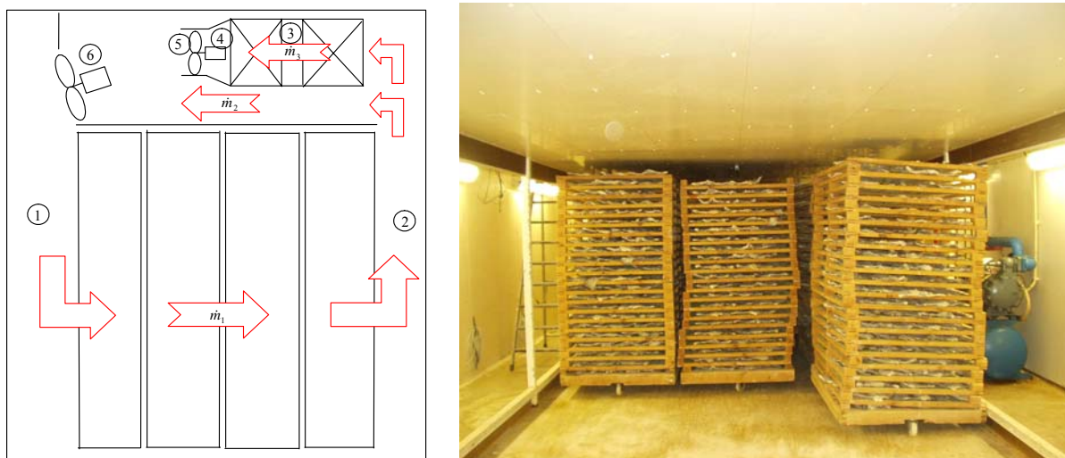
Figur 4: Tverrblåst tunnel. A: Skisse tverrsnitt med luftsirkulasjon ved rett luftsirkulasjon. B: bilde av delvis innlastet tunnel.
