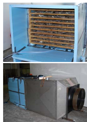
Figur 1. Arrangement og målt trykkfall avhengig av lufthastighet over vogn. Brettstørrelse: 1,0 x 1,5 m, Klosshøyde: 50mm, sei 1,0 kg, tykkelse 30 mm; 17,7 kg saltmettet fisk /brett.
