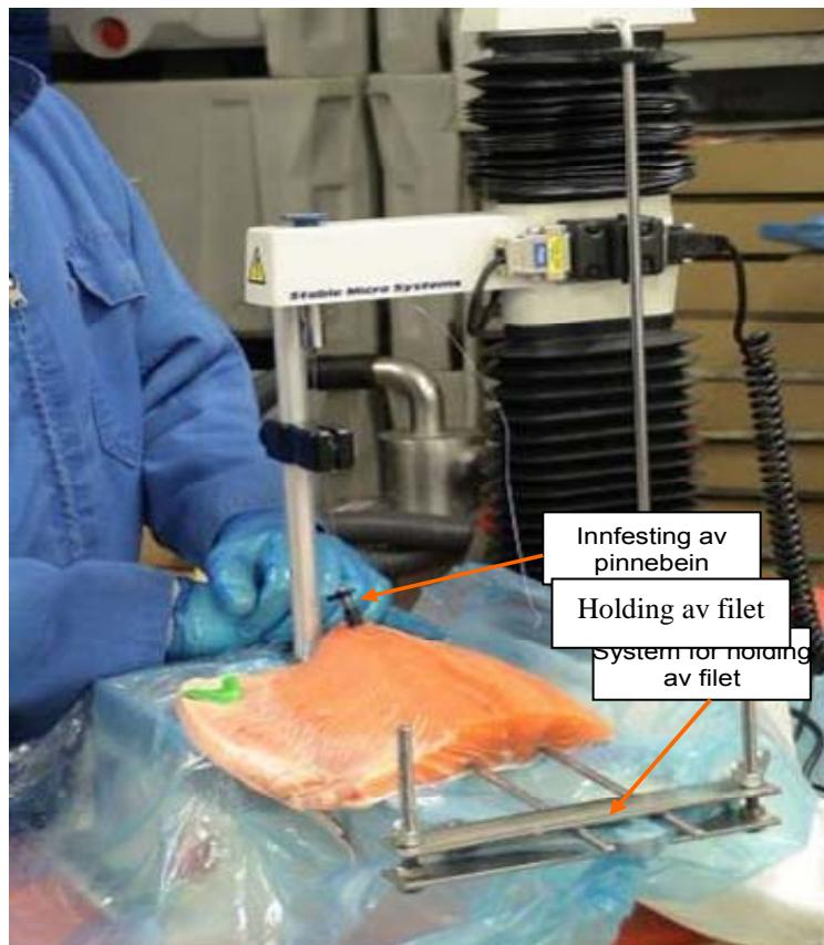
Figur 2.5; Oppsett for å måle trekkraftbehov ved uttrekk av pinnebein i laksefilet med teksturinstrumentet TA-XTPlus.
