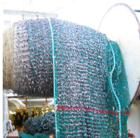
Figur 5. Eksempel på kledning av trålnota med lodde.
