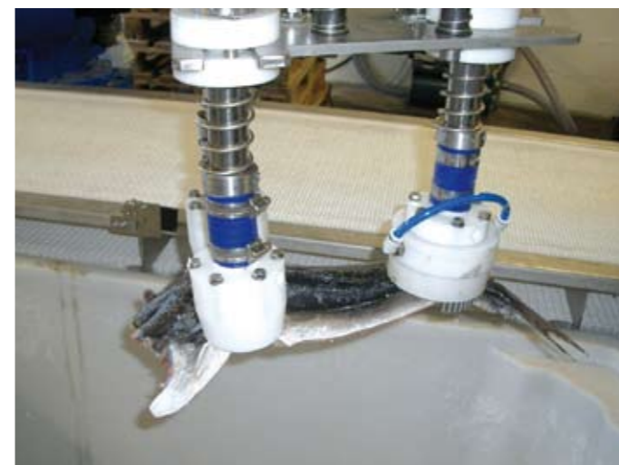
Versjon av patentert gripehode
