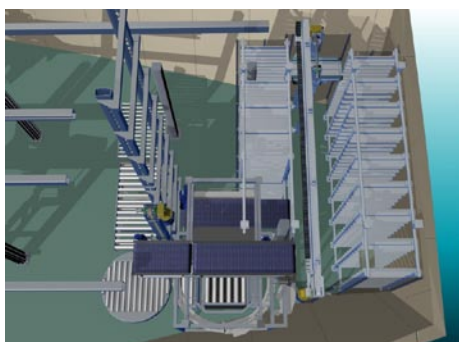
Mellomlager og palleter
