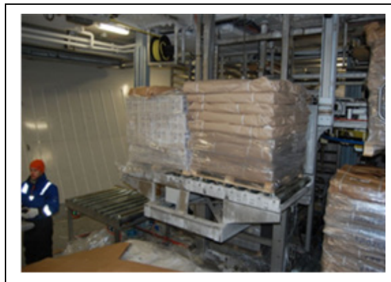
Bilde 14 To paller på palleheis til shelterdekk
