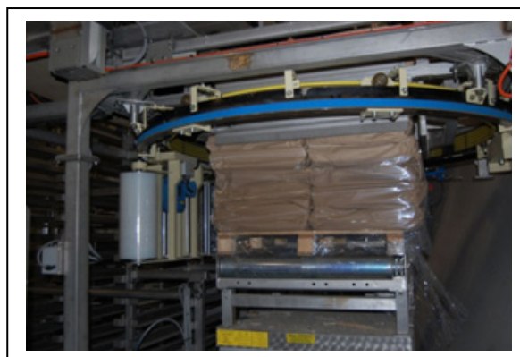
Bilde 10 Plasting av HG-pall på saksebord
