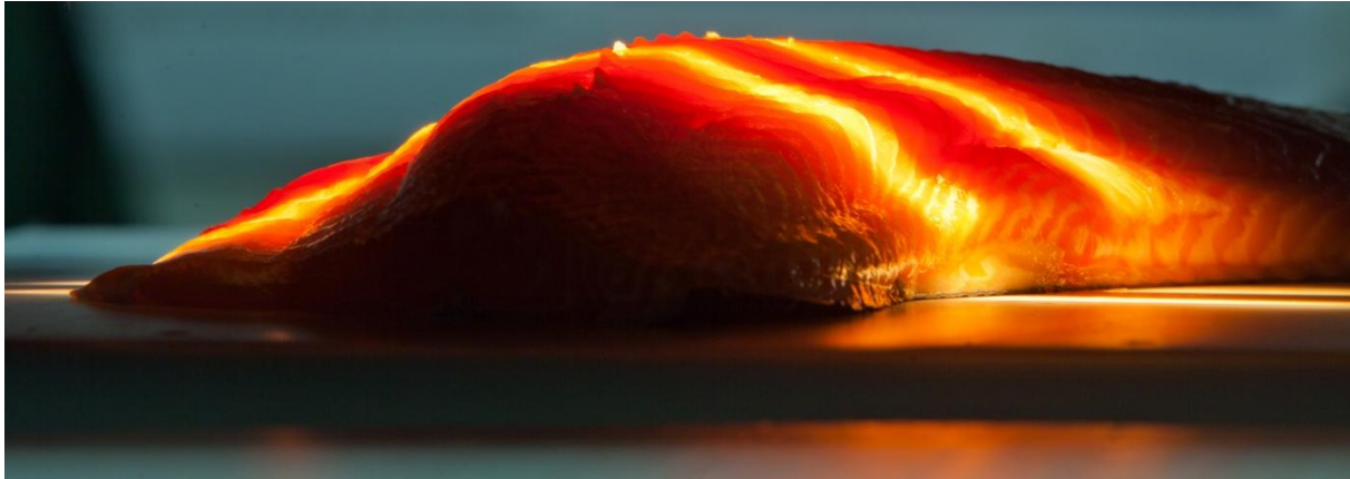
Figur 8 Laksefilet med projiserte lyslinjer som viser interaktansoppsettet. Spektrografen registrerer hvor mye lys som kommer ut av fileten midt mellom lysstripene.
