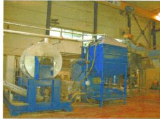
Figur 3 TMD installasjon i drift ved Soilcare AS. Anlegget prosesserer bioslam fra Mongstad raffineriet.
