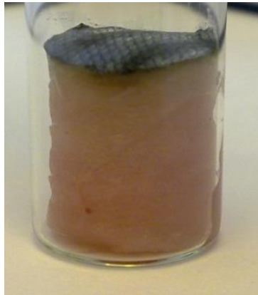
Figur 12 Bildet viser en sylinder (22 mm x 18 mm) med fiskemuskel som er boret ut fra skinnsiden (skinnet ses på toppen av sylindere). Sylindere er plassert i bunnen av et NMR-prøverør av glass. For hver 0,35 mm i høyden måles det en verdi som er proporsjonal med fettinnholdet
