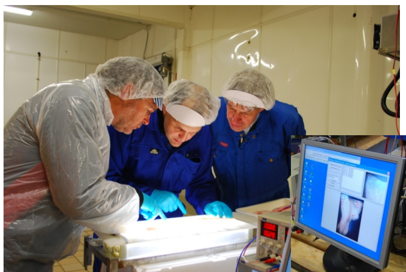
Figur 2 Manuell inspeksjon på lysbord. Alle potensiell flekker ble snittet og undersøkt. Kveis ble registrert direkte i bildet fra inspeksjonsmaskinen og senere brukt for å evaluere ytelsen til systemet.
