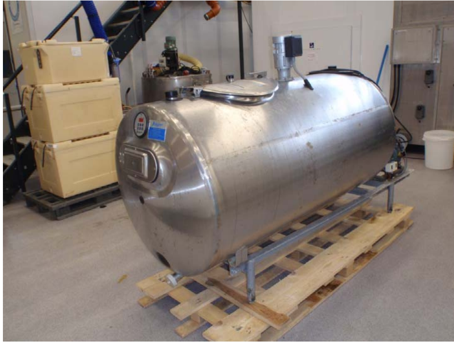
Bilde 1 Kjøletanken som ble benyttet til RSW-kjøling.
