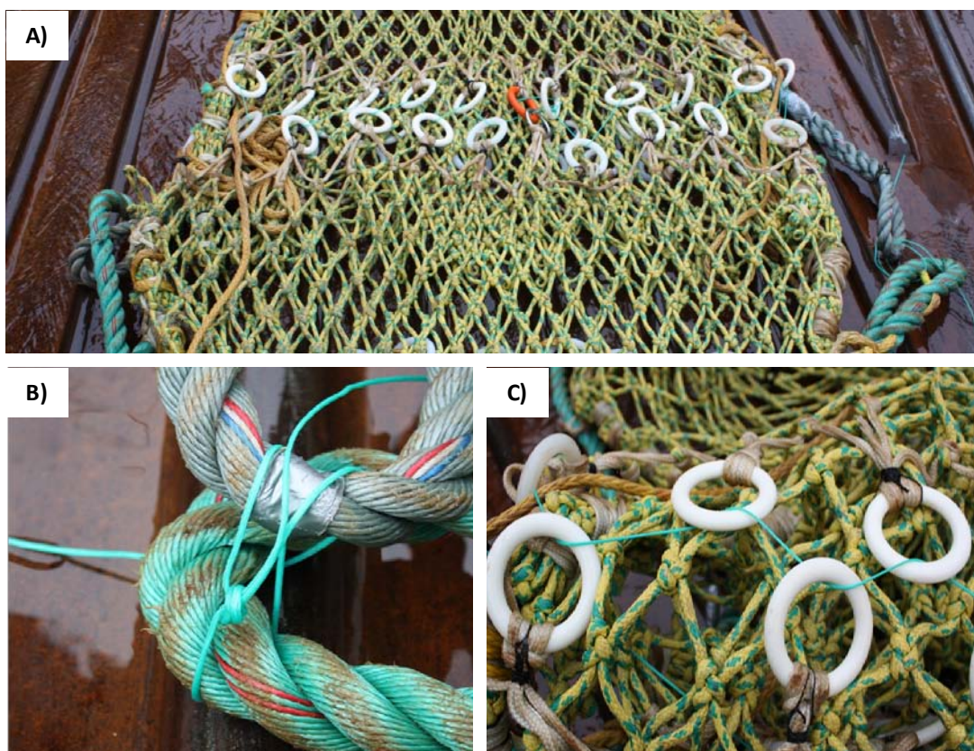
Bilde 20: Sekken og forlengelsen ble koblet sammen med hjelp av en tynn 1.8mm PE tråd.
