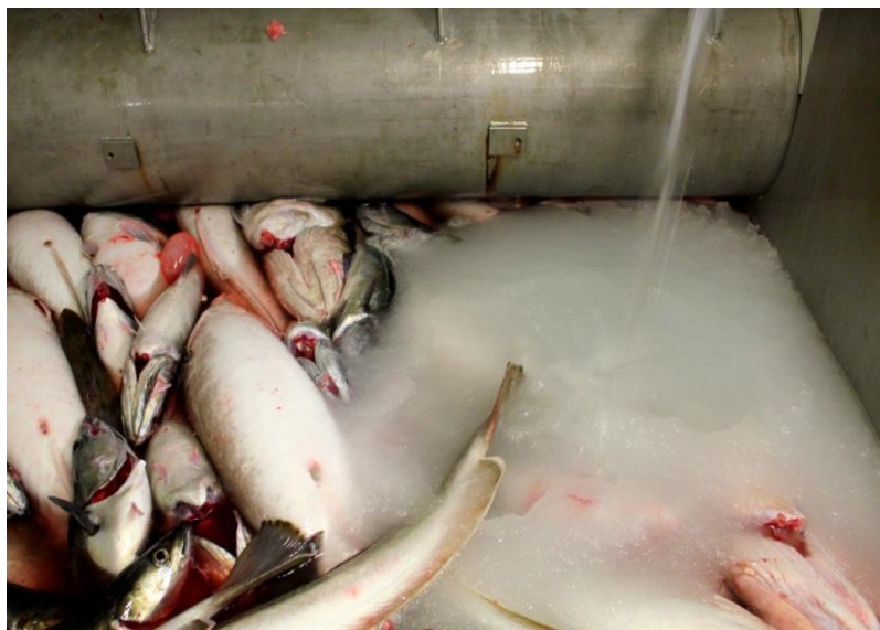
Figur 2.4 Isslurry fylles i ublødningkaret.
