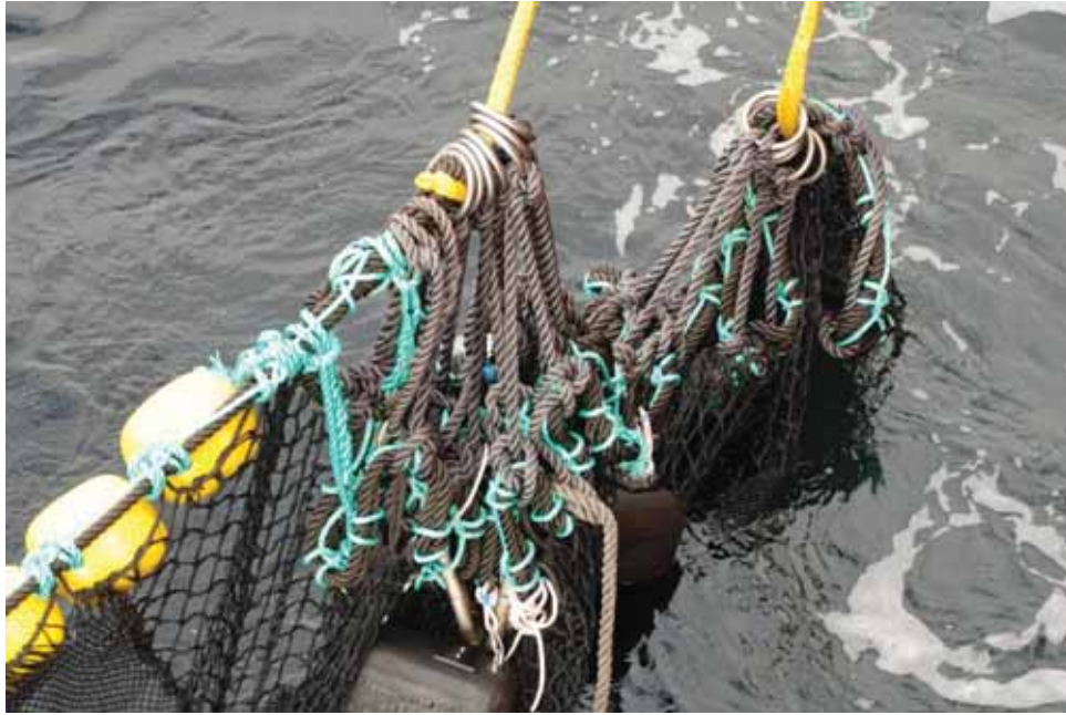
Figur 14. Dobbelt geiltau gjennom de to midterste ringene på brystet, ett opp mot ørekalven og ett ned mot ”skråttingen”.
