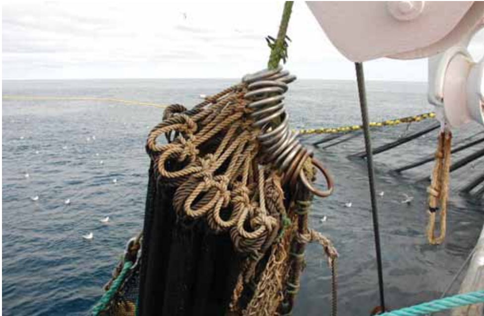
Figur 5. Notbryst med enkelt geiltau med stoppe-ring i enden, korte haneføtter.
