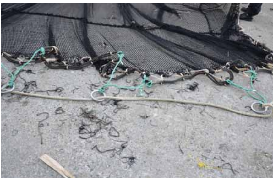
Figur 8. Ombygd notbryst: Blytauet er fjernet, ringer skåret vekk fra fellingsstauet, og montert i 60 cm lange haneføtter.
