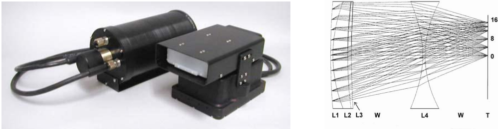
Figur 18. ABIS sonar med akustiske linser for ROV inspeksjon; 6 Hz, 1 cm oppløsning på 3 m avstand.
