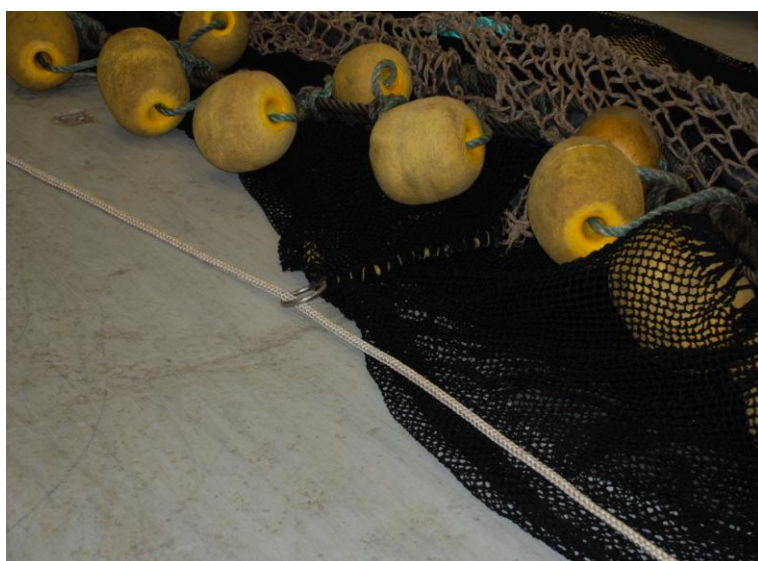
Figur 6. ”Jolletau” tredd gjennom stålringer som var montert langs, og ca 20 cm under flåtelna.
