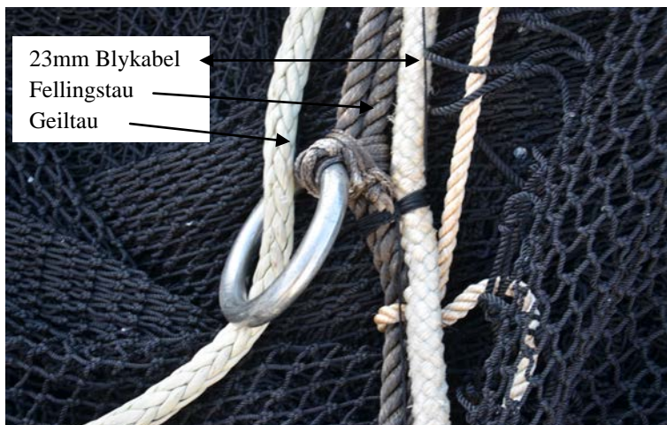
Figur 5. Rigging av 23 mm blykabel, dobbel fellingstau, stålringer og geiltau på forsøksnot..
