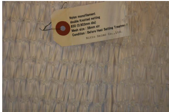
FIGUR 6. TRANSPARENT NYLON MONOFILAMENT LIN BENYTTET I SISTE VERSJON AV "USYNLIG KISE" I RINGNOT. HELLER IKKE DETTE VAR VELLYKKET.
