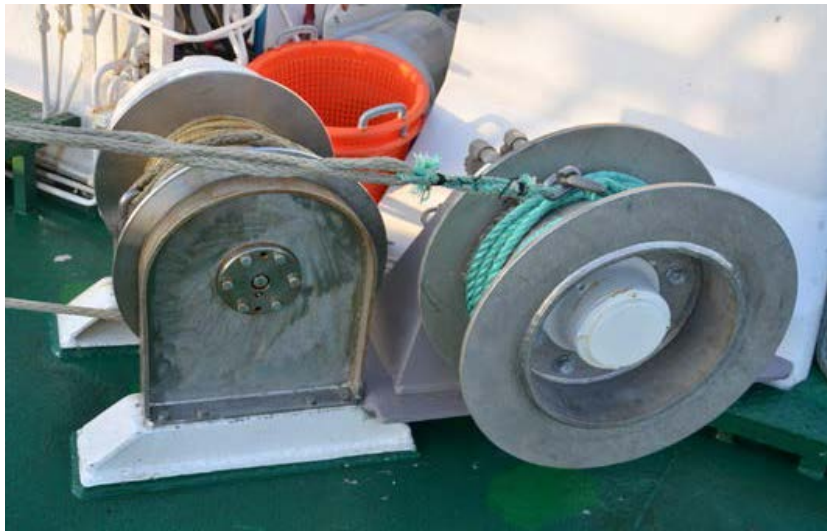
FIGUR 24. SEPARATE VINSJER FOR GEILTAU OG FLÅSNURPE.
