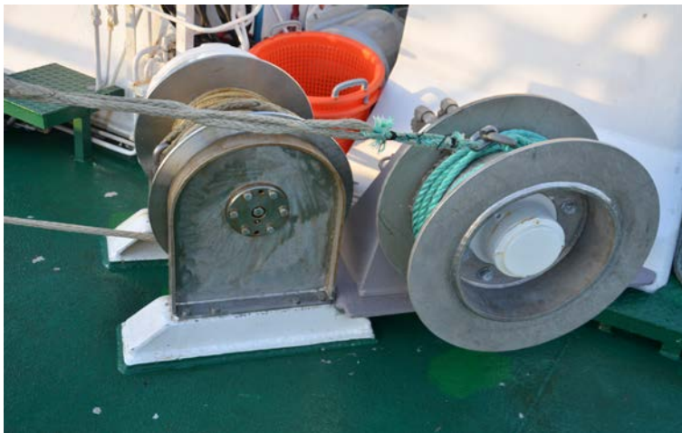
Figur 2. Separate vinsjer for geiltau og flåsnurpe.
