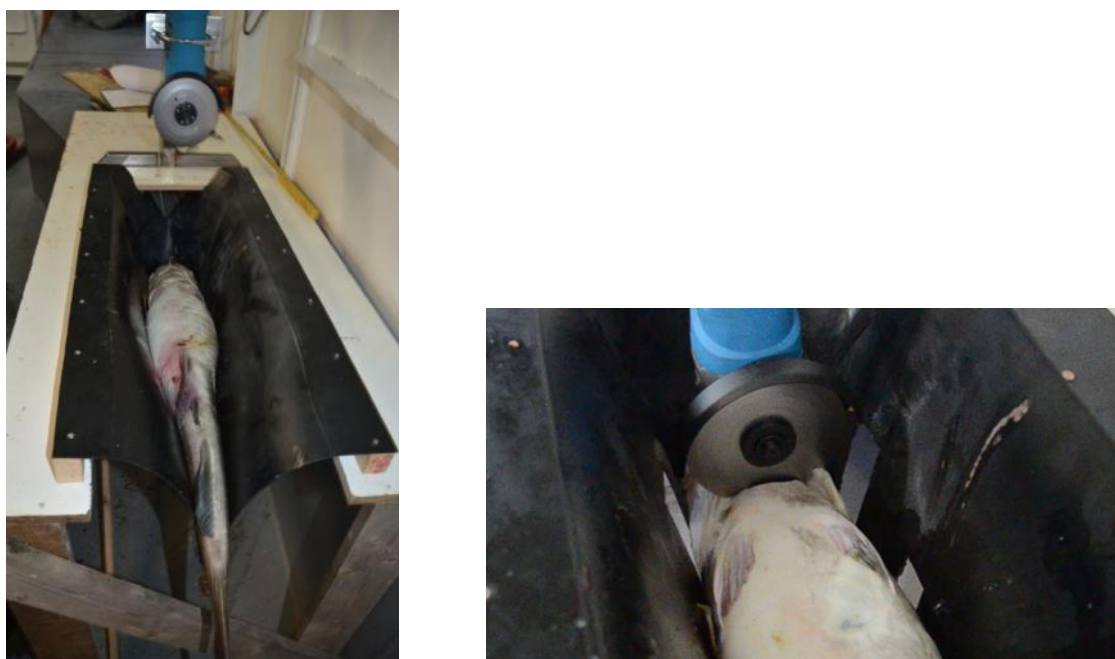
Figur 13 – Fikseringsskål (venstre bilde) og roterende kniv (høyre bilde) fastmontert om bord på M/S Harhaug.
