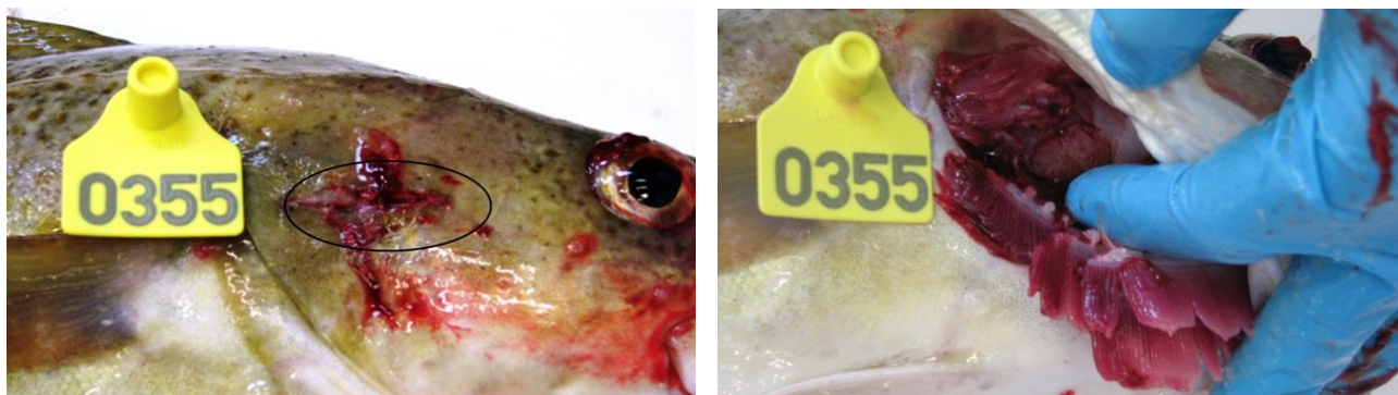
Figur 4 – Automatisert bløgging krever at man kan identifisere et passende stikkpunkt for kniven. Bildet til venstre viser knivens treffpunkt styrt av maskinsyn. Stikkpunktet ble automatisk beregnet ut fra en tenkt linje mellom øvre del av brystfinnen og øyet. Et passende stikkpunkt ligger midtveis på denne linjen. Bildet til høyre viser at gjellebuer kuttet ved bruk av denne metoden.
