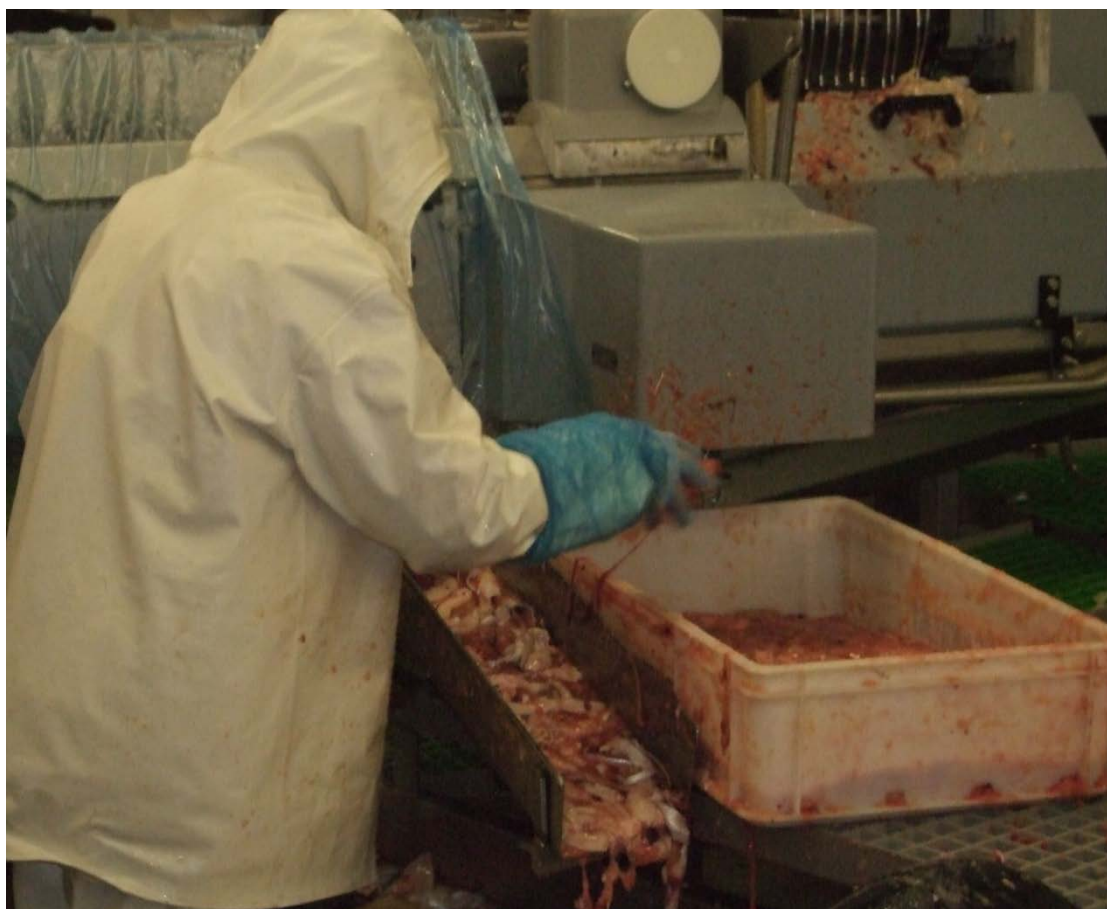
Figur 11. Manuell plukking av silderoغن (separering fra øvrig bukholeinnhold) fra uttaksrenne under filetmaskin.
