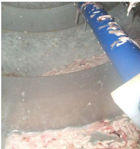
Figur 12. Oppkuttet melke og innvoller i rotosil i prosessanlegg for løstrognproduksjon. Som vi ser er melken her svært oppdelt og delvis oppløst.
