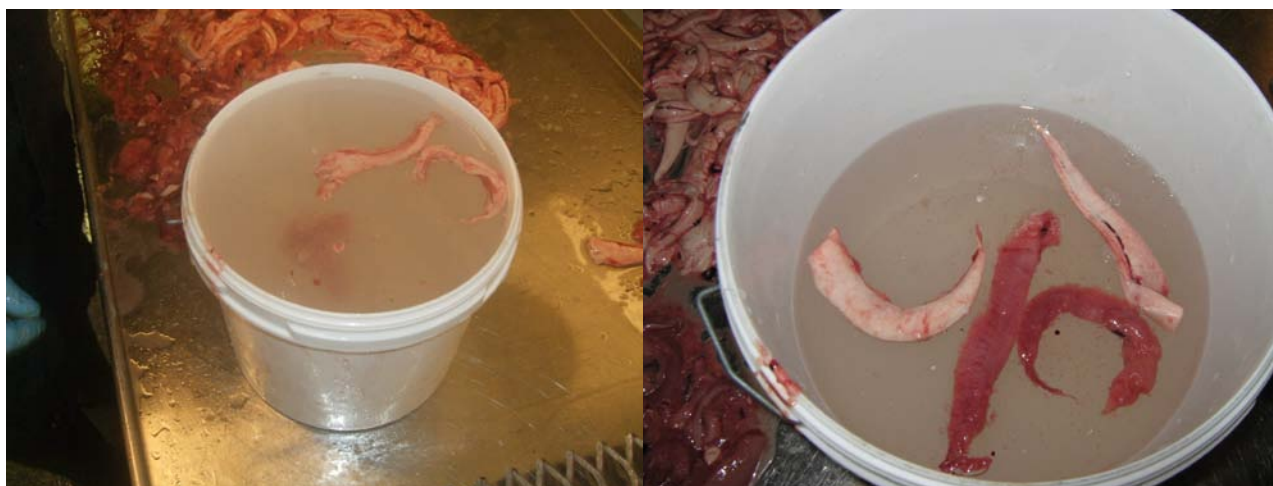
Figur 16 Flotasjon. Ved en gitt saltkonsentrasjon flyter melke opp og rogn synker til bunn (til venstre). I ferskvann flyter begge (til høyre).
