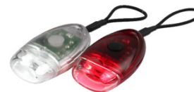
Figur 6-4: LED lys støpt inn i sensorfisk
