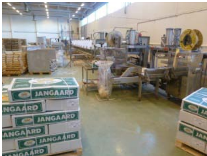
Figur 1 a og b – Pakkelinjen ved Jangaard Export AS sitt anlegg på Kleivane i Ålesund. (a) Klippfisk av godkjent tørrhet, klassifisert som 'superior' eller 'sortido', legges på båndet for automatisk veiing, merking (maskin vist midt i bildet), og sortering med hensyn på vekt i fire vektklasser; (b) Enden av prosesslinjen hvor eskene stropes før de stables på paller.
