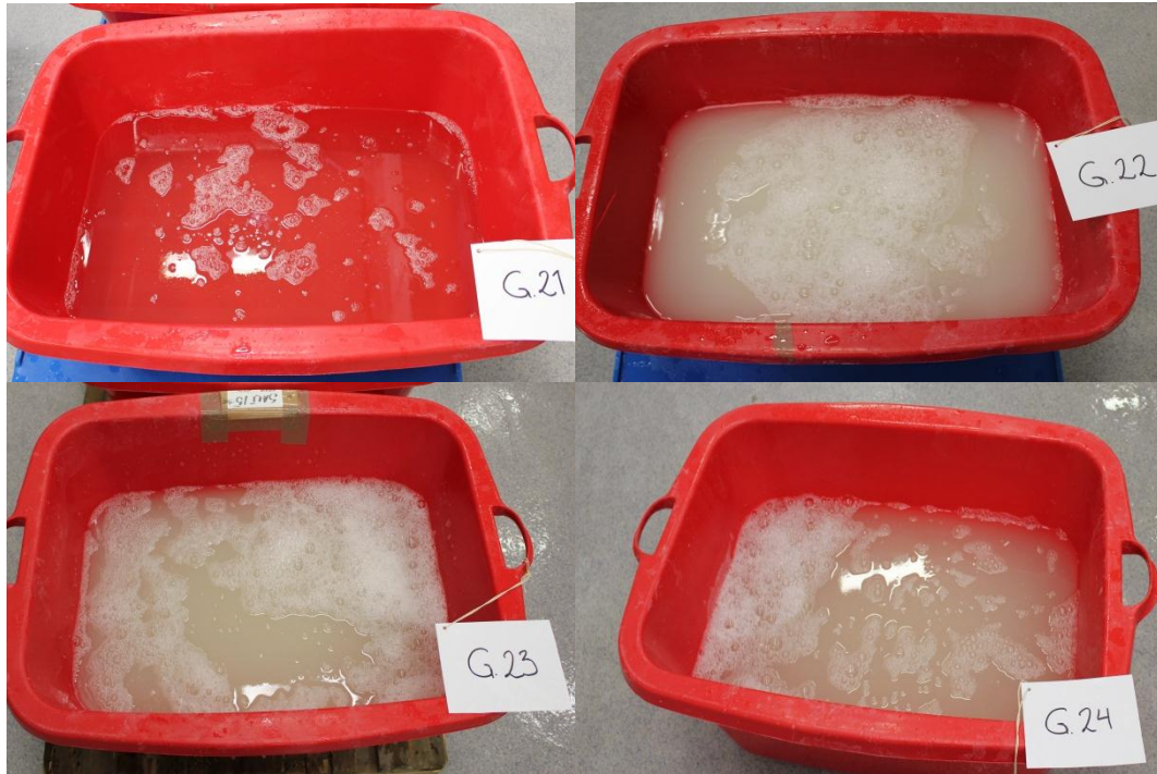
Figur 3.1. Laker etter endt lakebad i 24 timer ved 1-2 °C. G21 er kontroll, G22 tilsatt 0,4 %, G23 tilsatt 0,8 % og G24 tilsatt 1,6 % fosfat.
