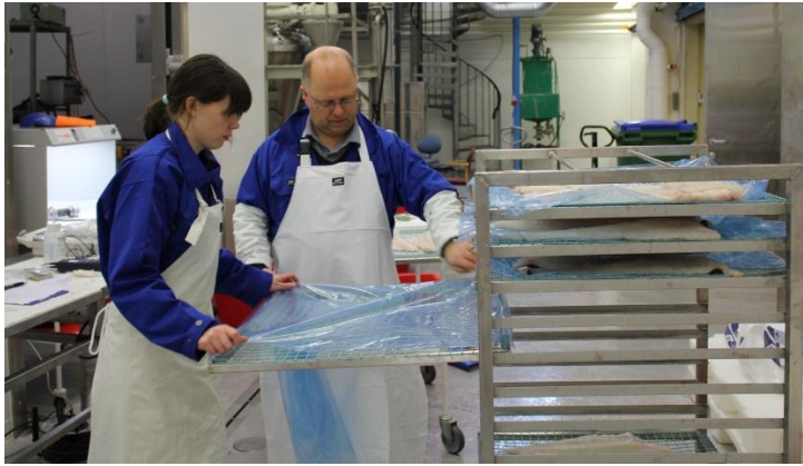
Figur 2.1. Anretning av lettsaltede fileter for innfrysing over natt ved -40^{\circ}\text{C} .
