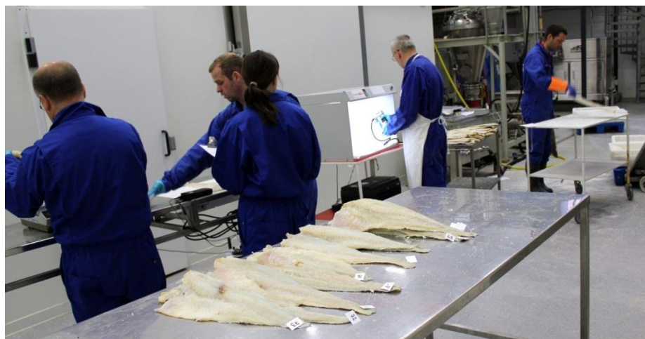
Figur 3.2. Analysering av saltfilet: Fra høyre fjerning av overflatesalt, fargemåling, pH-måling og veiing.
