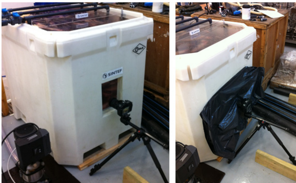
Figur 6: Kamera plassert i observasjonshullet og dekket med plast for å unngå refleksjoner (SINTEF, 2011)
