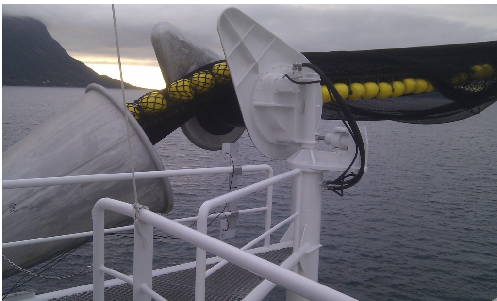
Figur 3: Antennene ble installert ved utløpet av notrøret.
