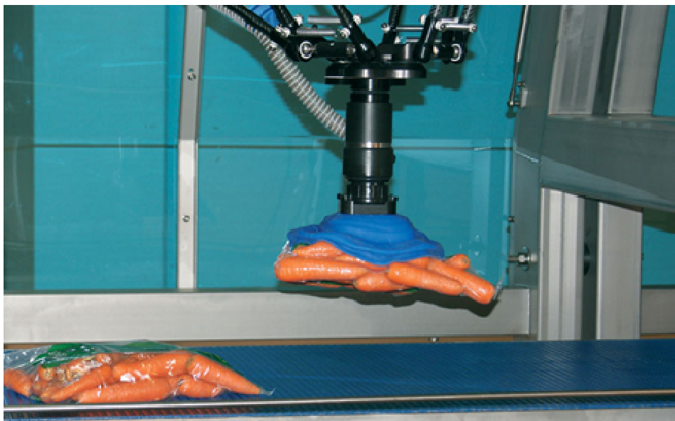
Figur 8 Octomations octogripper pækker gulrotsekker
