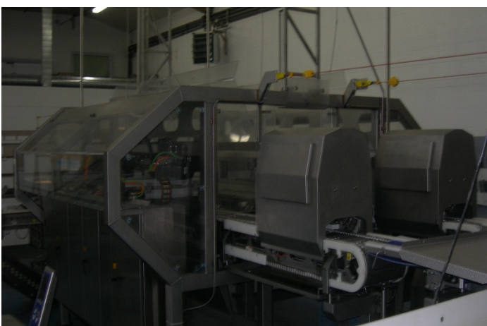
Figure 10. Fileteringslinje med CBC-kjøler og vannjetskjæring.
