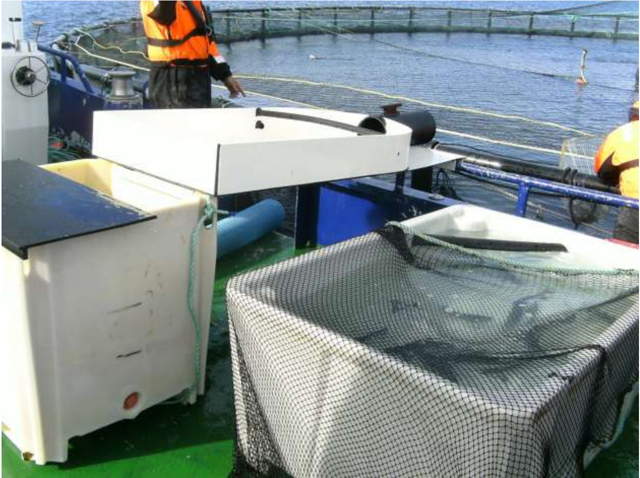
Bilde 1: Oppholdskar med gjennomstrømming (t.h) – dekket av not for å unngå at fisken hopper ut på dekk. Bedøvelseskar med veiebord (t.v.). Tellebord med vanntilkobling (ikke montert på bildet) og rør for montering av slange tilbake i merda (øverst). Foto: Arve Nilsen, Veterinærinstituttet
